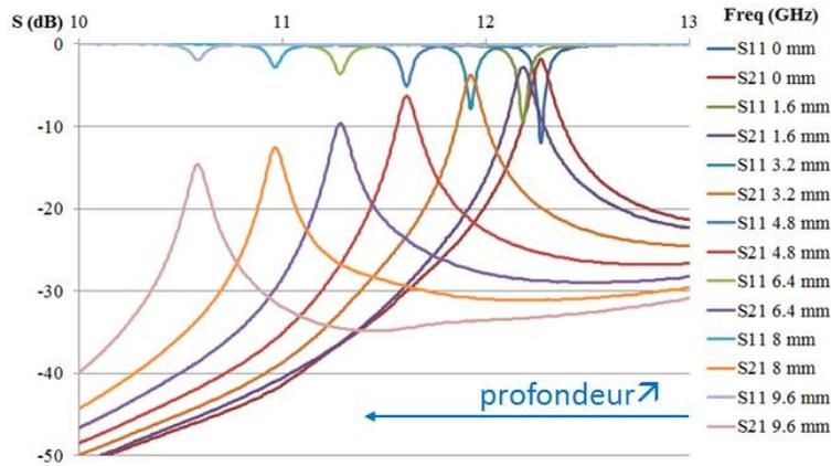
Fig.8. Mesures d'un résonateur en fonction de la longueur de vis dans la cavité
