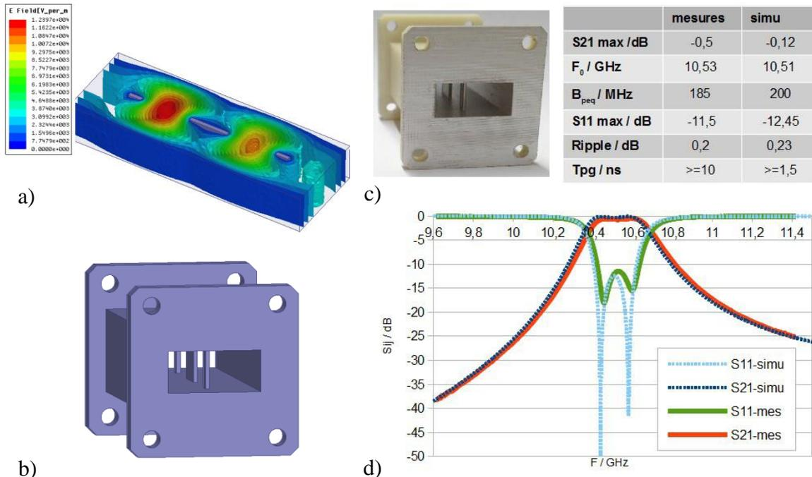
Fig.3. a) Isovaleurs du module du champ électrique dans la structure b) Dessin 3D du filtre ([format STL téléchargeable](#)) c) Dispositif imprimé en ABS et peint à la peinture argent, comparaison mesures et simulations d) Comparaison mesures et simulations des  $S_{ij}$  du filtre 2 pôles plan-E.
